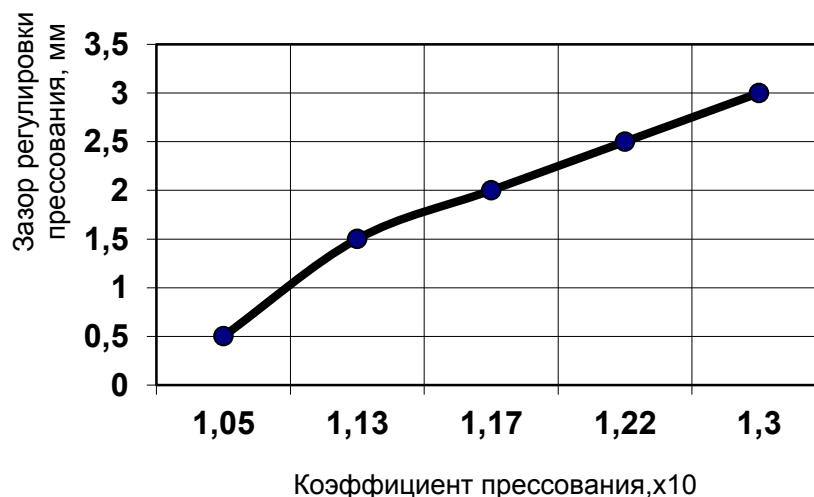
Рис. 2. Тарировочный график зависимости зазора прессования от коэффициента прессования K
