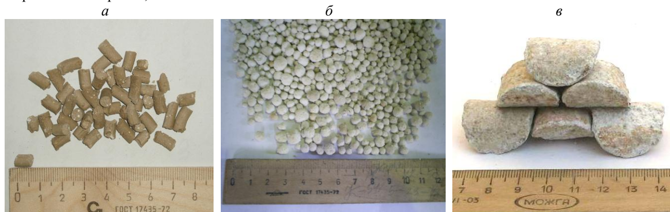
Рис. 6. Сформованные гранулы и брикеты в ВЦГ (а), ПВЭ (б), ПВА (в)
