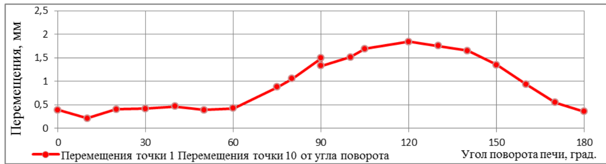
Рис. 9. График перемещений контура в точке 10 (рис. 5, б) радиального сечения бандажа в зависимости от угла поворота печи относительно её начального положения.
