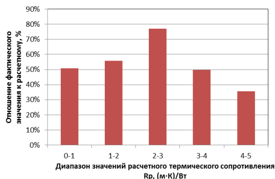
Рис 2. Снижение термического сопротивления в зависимости от: а) расчётного термического сопротивления; б) количества слоёв
